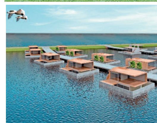
De huizen van Watergaten zijn omgeven door beton, waardoor schommelingen in de waterstand geen schade kunnen aanrichten.
